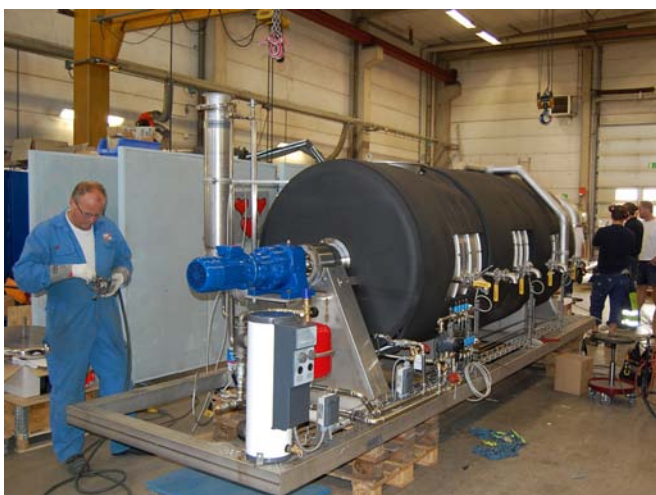
Biogasreaktorn MR 120. Foto: Teknikfabriken AB.
